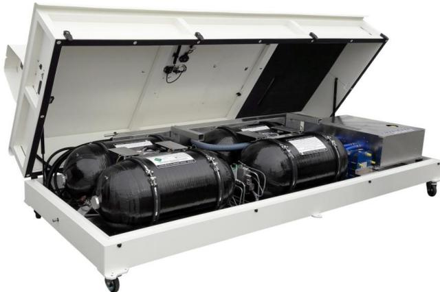
Banc : 4 réservoirs 350bar, au total 7kg
